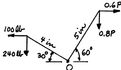
$$+\circlearrowleft \Sigma M_O = 240(4 \cos 30^\circ) + 100(4 \sin 30^\circ) - 0.8P(5 \cos 60^\circ) - 0.6P(5 \sin 60^\circ) = 0$$
