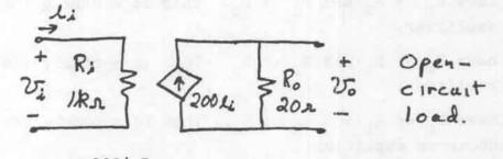
$$A_{VO} = \frac{v_O}{v_i} = \frac{200i_i R_O}{i_i R_i} = 4$$
