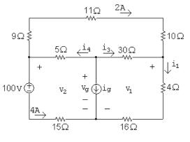
$\begin{aligned} v_2 &= 100 + 4(15) = 160 \,\mathrm{V}; & v_1 = 160 - (9 + 11 + 10)(2) = 100 \,\mathrm{V} \\ i_1 &= \frac{v_1}{4 + 16} = \frac{100}{20} = 5 \,\mathrm{A}; & i_3 = i_1 - 2 = 5 - 2 = 3 \,\mathrm{A} \\ v_g &= v_1 + 30i_3 = 100 + 30(3) = 190 \,\mathrm{V} \\ i_4 &= 2 + 4 = 6 \,\mathrm{A} \\ i_g &= -i_4 - i_3 = -6 - 3 = -9 \,\mathrm{A} \end{aligned}$
